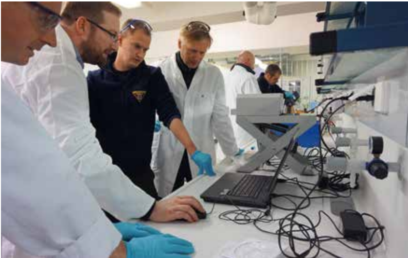
Einweisung in die analytische Messtechnik der ATF, hier Röntgenfluoreszenzspektrometer (RFA)
