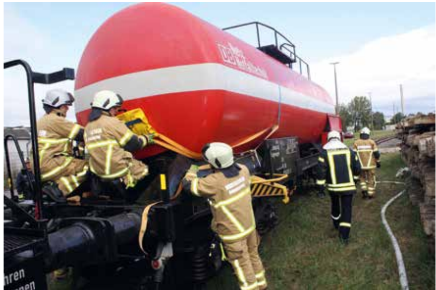
Anbringen der Leckdichtkissen
