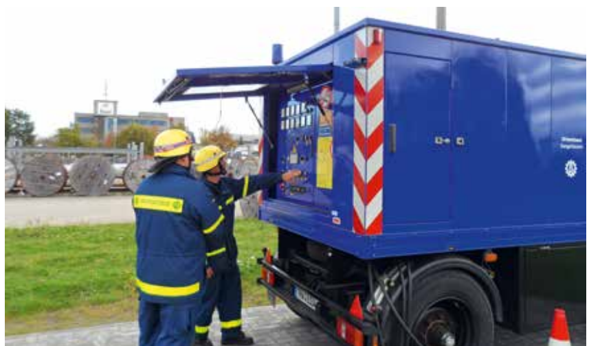
Übung mit der Netzersatzanlage (NEA)
